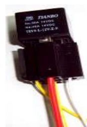
διακόπτης διακοπής λαδιού & ρεύματος
